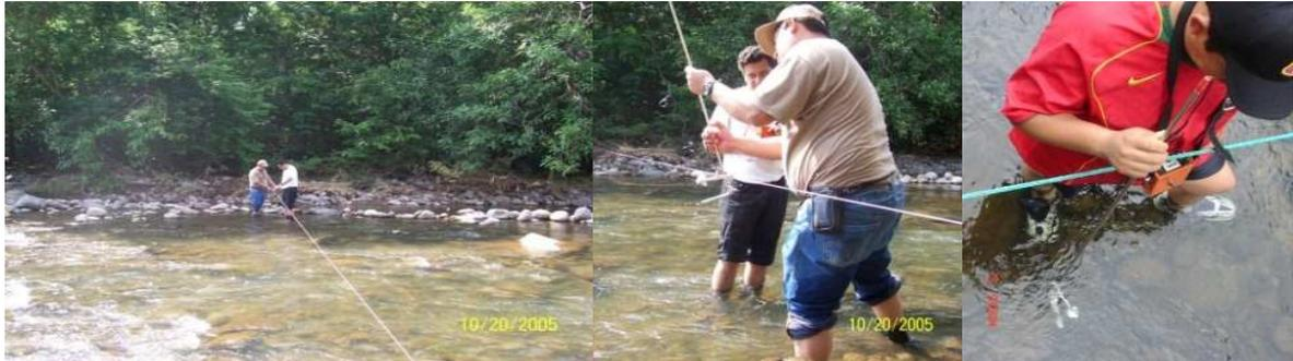
Figura 3 Medición del caudal del Río Guayapa de la Región hidrográfica C en el departamento de Ahuachapán, utilizando un molinete marca AOTT.
