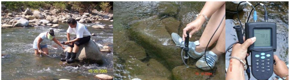
Figura 4 Determinación en campo de parámetros físico-químico para el análisis de la calidad de agua de los ríos Cara Sucia, San Pedro Belén, El Naranjo y Copinula de la región Hidrográfica "C" de El Salvador, utilizando una sonda multiparametro.
