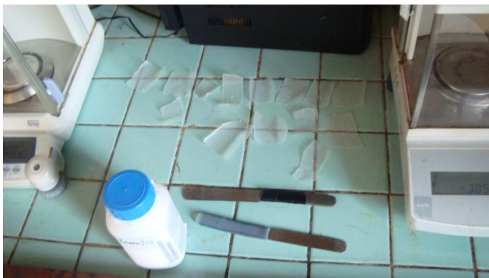
Figura III-3: Medición de las masas de cloruro de sodio a utilizar para obtener la curva de calibración. Fecha: 22/05/2013.
