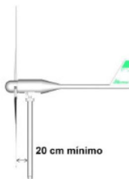
**Figura 42:** Distancia mínima entre la hélice y la torre de sujeción.
