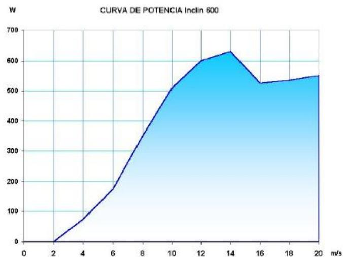
**Figura 40:** Curva de Potencia para el aerogenerador Inclin 600. Fuente: Bornay.
