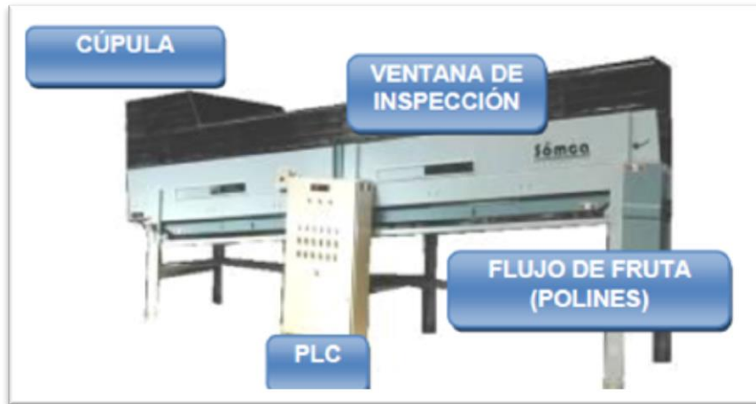
Ilustración 38: Principales componentes internos túnel de secado.
