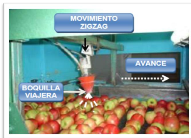
Ilustración 36: Sistema de encerado de fruta con boquilla viajera.
