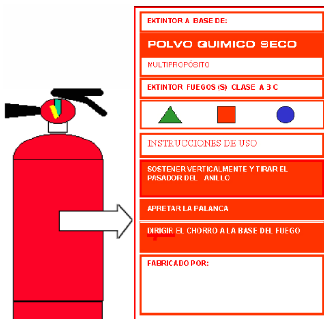
Ilustración 9. Etiqueta de identificación del extintor
