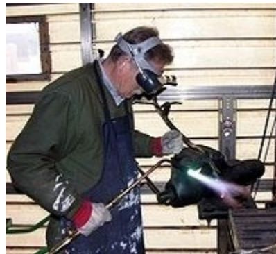
Figura 2: Soldadura autógena (oxiacetilénica)
