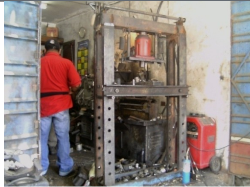
Foto. 32 Riesgos: Eléctricos, Físicos y Mecánicos. Operario trabajando en un espacio pequeño, además de contar con una prensa hidráulica llena de sobrantes metálicos que no han sido apartados..
