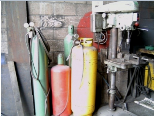
Foto. 33 Riesgos: Eléctricos, Físicos y Mecánicos. Cilindros para efectuar soldadura autógena cerca de otras maquinarias y materiales varios, sin tener espacio por cualquier fuga que se pueda generar.
