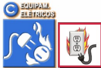
Ilustración 5. Instalaciones Eléctricas producen incendio Clase C
