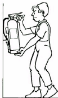
Ilustración 10. Descolgar el extintor
