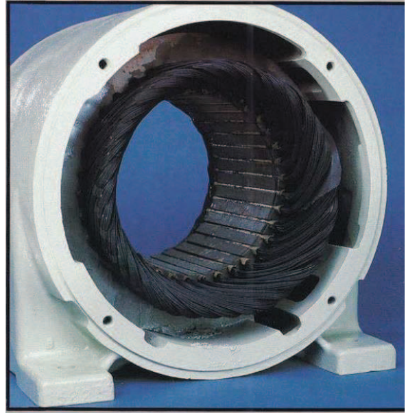
Figura A8.11: El deterioro térmico del aislamiento en todas las fases del devanado del estator típicamente es causado por demandas de carga superiores a la capacidad nominal del motor. Nota: Baja tensión y sobre tensión (excediendo los estándares NEMA) darían como resultado el mismo tipo de deterioro en el aislamiento.
