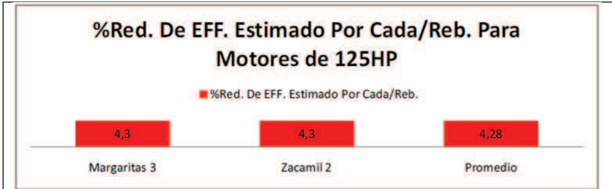
Figura 3: Porcentaje de reducción en la eficiencia en motores de 125HP por cada rebobinado 11
