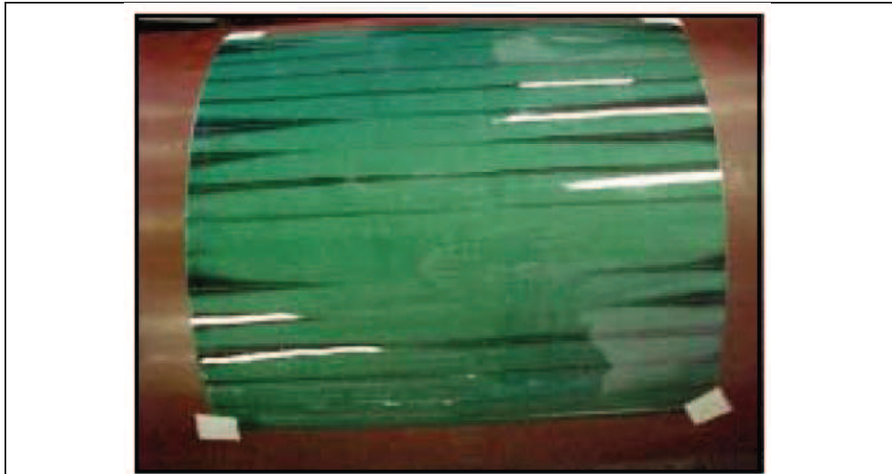
Figura A9.3: Utilizando papel magnetizante en la prueba growler puede facilitar la detección de barras abiertas en el rotor 75
