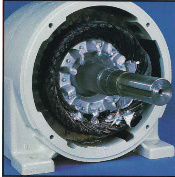
Figura: A8.12: Un severo deterioro térmico del aislamiento en todas las fases del motor, es normalmente causado por corrientes muy altas en el devanado del estator debido a una condición de rotor bloqueado, también puede ocurrir como resultado de arranques o inversiones excesivas.
