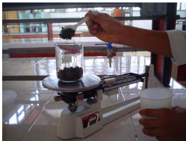
FIGURA No. 40 Operación de pesada de 20g de cáscara de Phaseolus vulgaris (Frijol Negro), para cada extracción.
