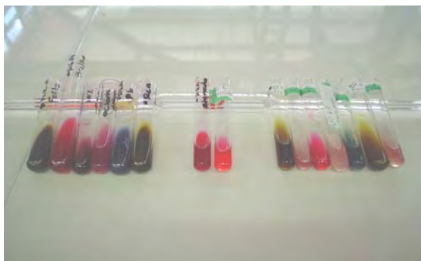
FIGURA No. 21. Resultados obtenidos de los ensayos fitoquímicos de los extractos R.E. de Phaseolus vulgaris (Frijol Negro) en estado Fresco. (2) (13) Donde A: Prueba con \text{FeCl}_3 ; B: Agua de bromo; C: Gelatina al 10%; D: Dicromato de Potasio; E: NaOH; F: Subacetato de Plomo; G: Shinoda, utilizando el extracto etanólico (R.E.) y los tubos restantes H, I J, K L, M, N, O son las mismas pruebas con el extracto etanólico acidificado (R.E.A.) para fines comparativos
