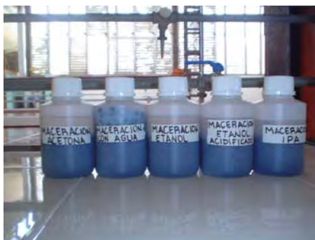
FIGURA No. 38: Proceso de hinchamiento de Phaseolus vulgaris (Frijol Negro), por medio de una leve maceración para la posterior remoción de la cáscara con los respectivos solventes.
