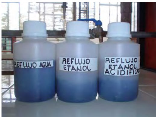
FIGURA No. 39: Proceso de hinchamiento de Phaseolus vulgaris (Frijol Negro), por medio de una leve maceración para la posterior remoción de la cáscara con los respectivos solventes para su posterior extracción por el Método Soxhlet.
