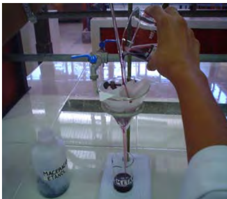
Figura No. 14 Filtración de los extractos obtenidos tanto por Maceración como por Reflujo con Soxhlet.
