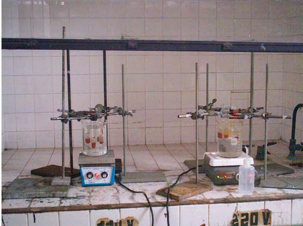
FIG. 2 DIGESTIÓN DE VAPORES EN CÁMARAS DE GASES
