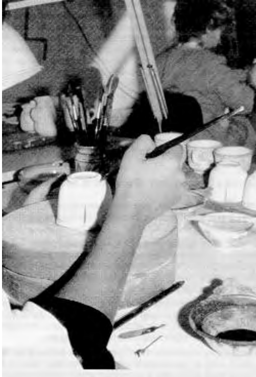
Fig. 2 Aplicación de pintura a pincel sobre la capa de barniz. (9)
