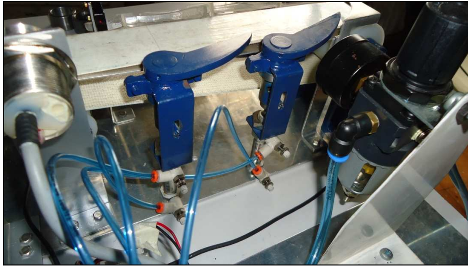
Figura 7.5 Montaje de separadores
