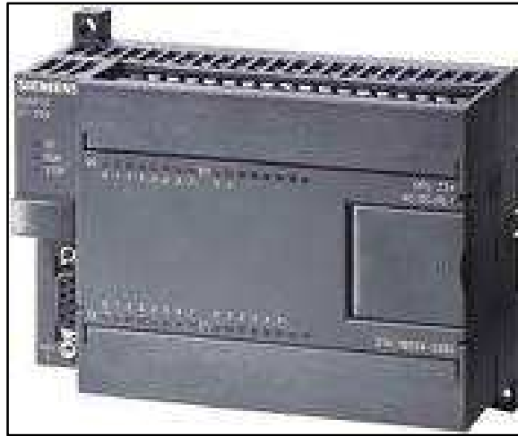
Figura 4.12 Autómata CPU 224 con salidas a relé y entradas a 24 voltios.
