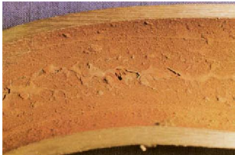
Fig. 24. Capas fragmentadas de hematita sobre la superficie interna de un tubo. Hubo mas óxidos formados en este sitio, pero algunos fueron removidos por fragmentos o astillas.
