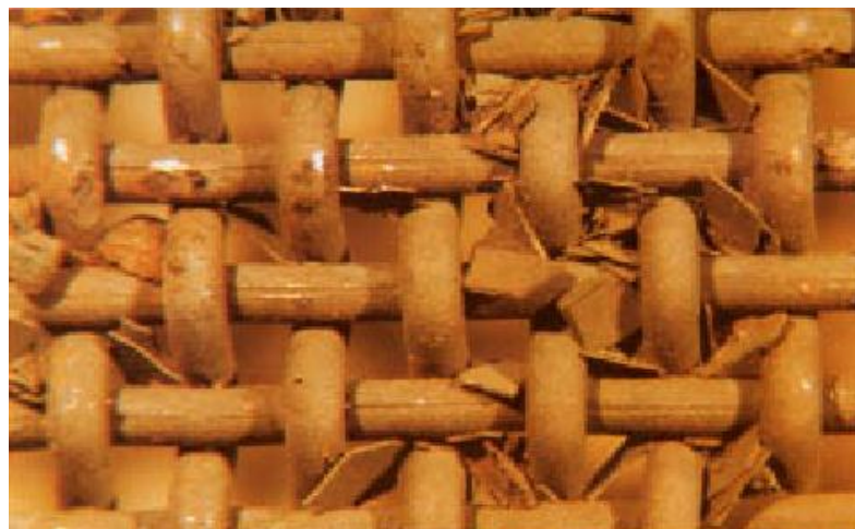
Fig. 18. Tamiz fino localizado a la entrada de la turbina el cual ha atrapado óxidos provenientes de las tuberías de los intercambiadores de calor. 7.5x
