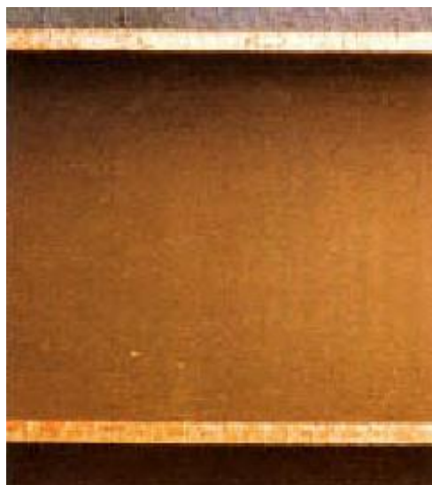
Fig. 20. Capa de magnetita plana, tenaz y negra al interior de un tubo de un intercambiador de calor.
