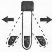
Pasados 10 minutos agitar la cubeta y, para que se enfríe completamente a aproximadamente 20 hasta 40 °C, volverla a colocar en el soporte.
