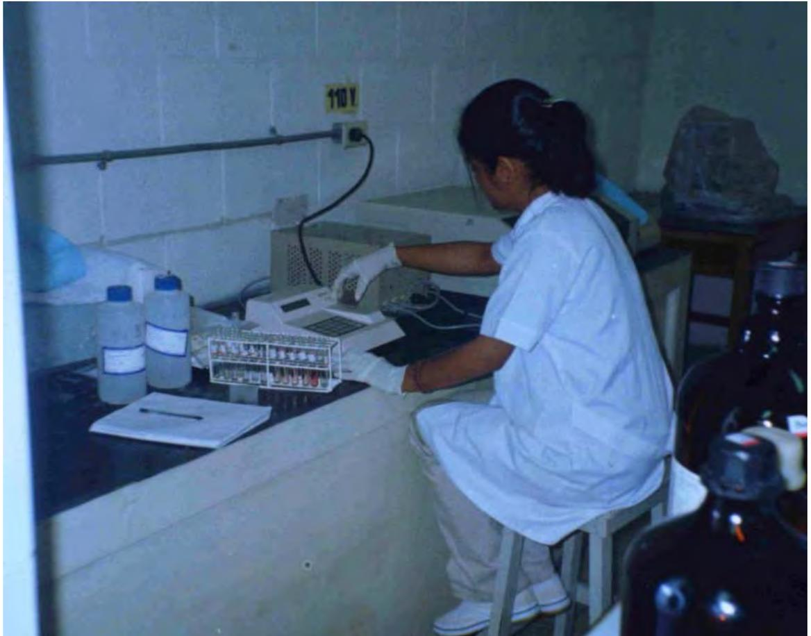
Figura N° 8. DETERMINACIÓN DE NITRITOS UTILIZANDO EL SISTEMA DE ANÁLISIS ESPECTROQUANT SQ 118
