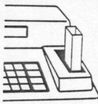
Sacar del compartimento la cubeta con la muestra en blanco. Colocar en el compartimento la cubeta con la muestra de medición.
