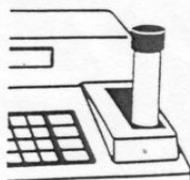
Sacar del compartimento la cubeta con la muestra en blanco. Colocar en el compartimento la cubeta de reacción con la muestra de medición. Raya marcada vertical dirigida hacia el operador.
