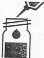
Pipetear 10 ml de la muestra en un frasco de ensayo (muestra de medición).
