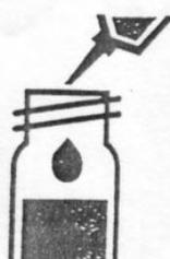
Añadir 5 ml de NO<sub>3</sub>-2A a ambos frascos de ensayo y disolver el reactivo NO<sub>3</sub>-1A.
