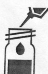
Añadir 1,5 ml de agua destilada en el segundo frasco de ensayo y mezclar (muestra en blanco).
