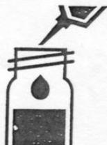
Introducir cuidadosamente 3,0 ml de solución de la muestra con la pipeta de embudo en una cubeta de reacción y cerrar firmemente con la tapa roscaada.
