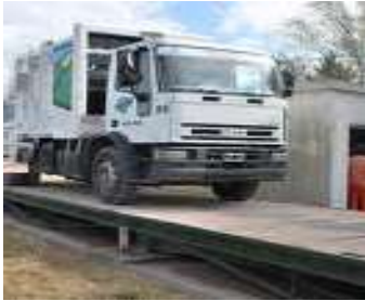
Grafico 6.2 Pesaje en báscula con capacidad de 50 Toneladas.
