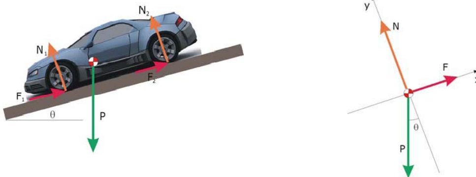
Figura 6 Fuerzas sobre un vehículo sobre una superficie con pendiente
