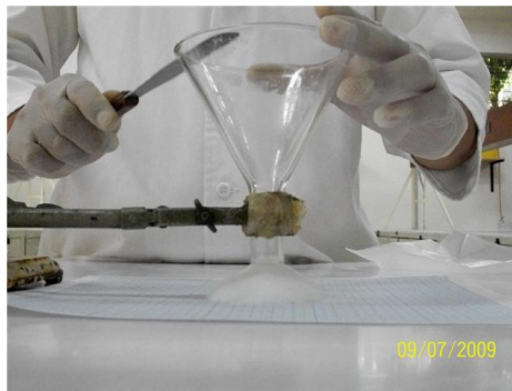
a) Formación del cono del dióxido de silicio por el método dinámico
