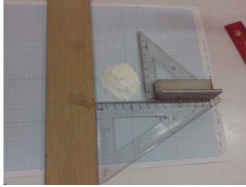
d) Medición del diámetro del cono de dióxido de silicio
