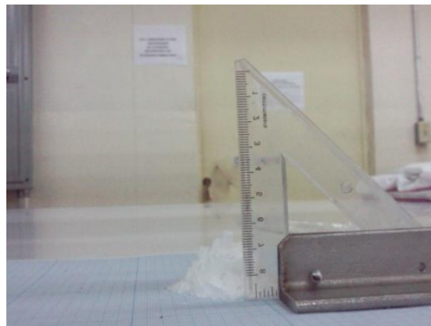
e) Medición de la altura del cono de dióxido de silicio
