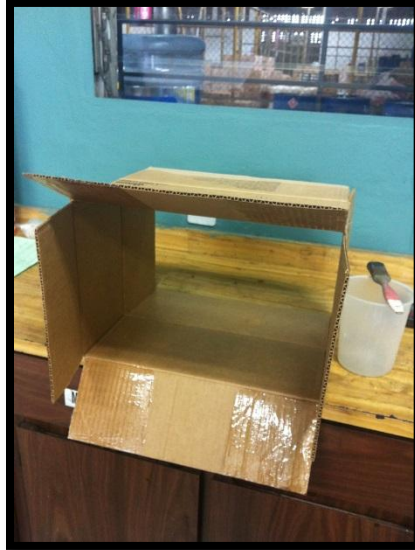
Figura 3-4-4. Caja de cartón con adhesivo en 4 pestañas. Fuente: Elaboración propia, 2013.
