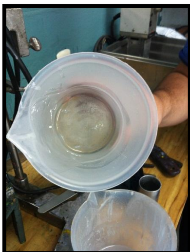
Figura 3-37. Pérdidas de solución en el proceso de obtención de adhesivo a partir de durapax. Fuente. Elaboración propia, 2013.
