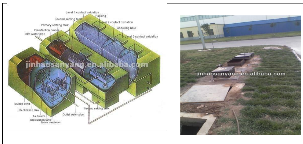
Figura 5-17. Esquema del funcionamiento del equipo de tratamiento de aguas e imagen de instalación finalizada.
