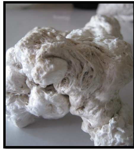
Figura 2-32. Extracción de oxígeno del durapax y muestra de pieza posterior al proceso. Fuente: [MARN, Unidad de Desechos Sólidos y Peligroso].
