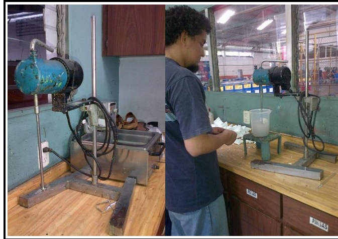
Figura 3-13. Disolución del durapax en butil acetato. Fuente: Elaboración propia, 2013.
