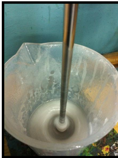
Figura 3-34. Disolución de durapax en etil acetato. Fuente: Elaboración propia, 2013.
