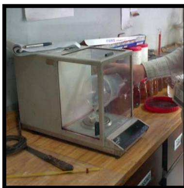
Figura 3-26. Adición y toma de peso de solución en cápsula. Fuente: Elaboración propia, 2013.
