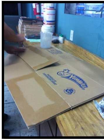
Figura 3-4-3. Aplicación de adhesivo en cajas. Fuente: Elaboración propia, 2013.
