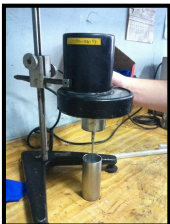
Figura 3-35. Medición de viscosidad solución etil acetato. Fuente: Elaboración propia, 2013.
