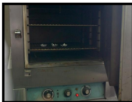
Figura 3-27. Colocar las cápsulas en un horno a 105°C por 2 hr aproximadamente. Fuente: Elaboración propia, 2013.
