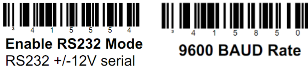
Figura 2.2 a) Programación del escáner al modo RS232 b) Cambio de velocidad de transmisión del escáner.
