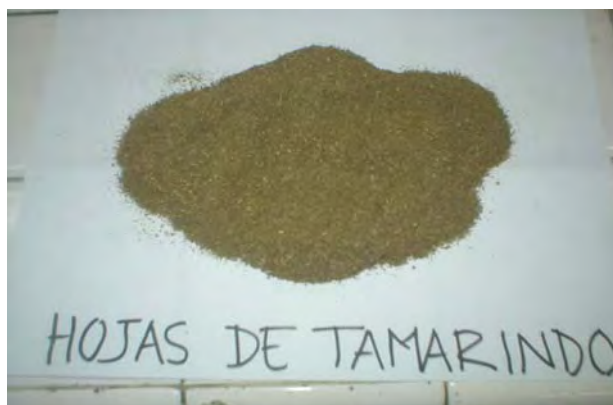
Figura № 17. Polvo suelto y granuloso en hojas de, Tamarindus indica . (Tamarindo), luego de la pulverización con el molino Thomas Willey.
