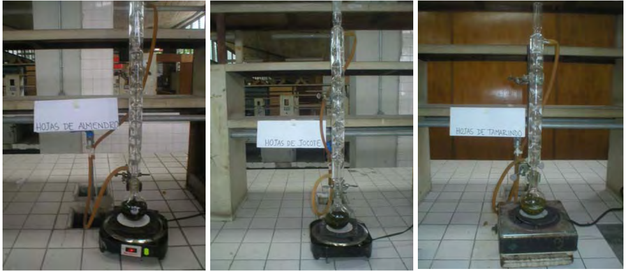
Figura № 24. Equipo de reflujo con hojas y corteza de las tres especies vegetales.
