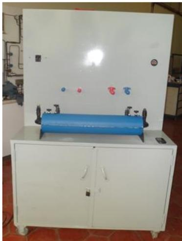
Figura 4.2 Intercambiador de calor en posición.
