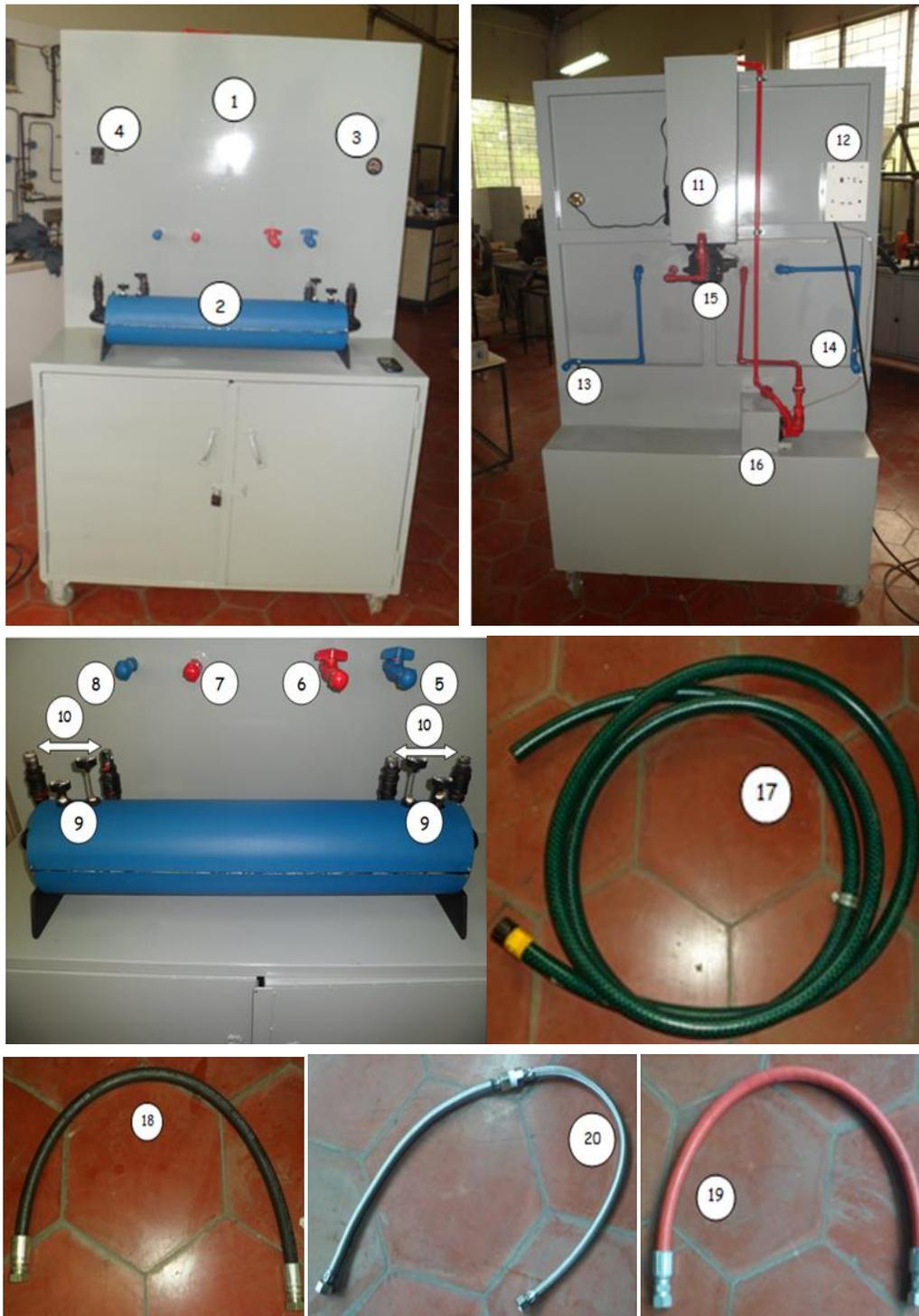
Figura 4.25 Especificación de ubicación de partes del banco de pruebas de intercambio de calor (para nombres de las partes referirse a la tabla 4.10).
