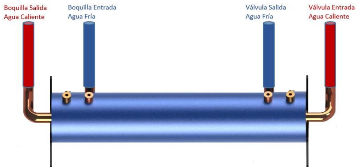
Figura 4. Esquema de conexión contraflujo a realizar en la práctica de laboratorio.
