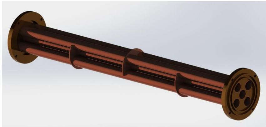
Figura 3.6 Muestra el intercambiador sin carcasa solo colocadas sus tapaderas.
