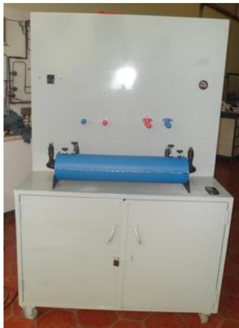
Figura 4.1 Banco de pruebas de intercambio de calor.
