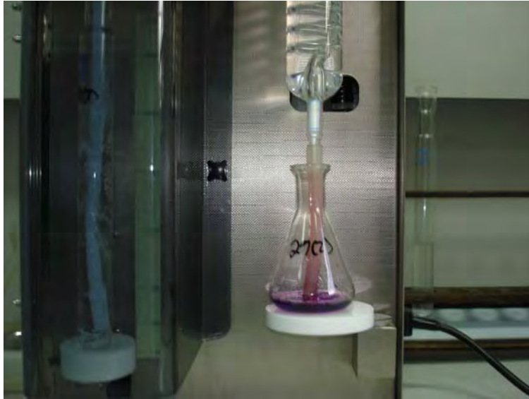
FIGURA N° 6 Proceso de Destilación para Determinar Proteínas
