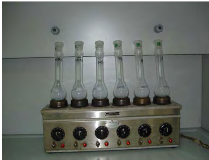
FIGURA N° 4 Digestión de las muestras para determinar proteínas
