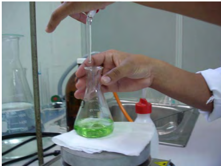
FIGURA N° 7 Titulación para Calcular la Cantidad de Proteínas.
