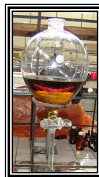
Separación agua/diclorometano en ampolla de separación
