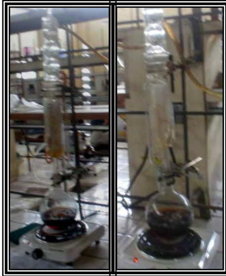
Figura No. 8 Aparato Soxhlet
