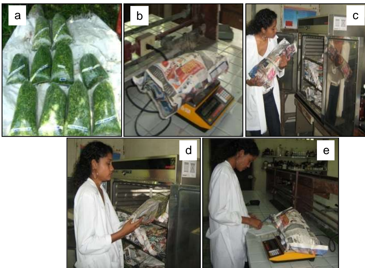
Figura 10. Pasos a seguir para la determinación de Humedad Parcial. (a) Recolección e identificación de muestra, (b) Embolsado y pesado de muestra, (c) Colocación de muestras en la estufa de aire, (d) Extracción de muestras de la estufa de aire circulante, (e) Pesado final.
