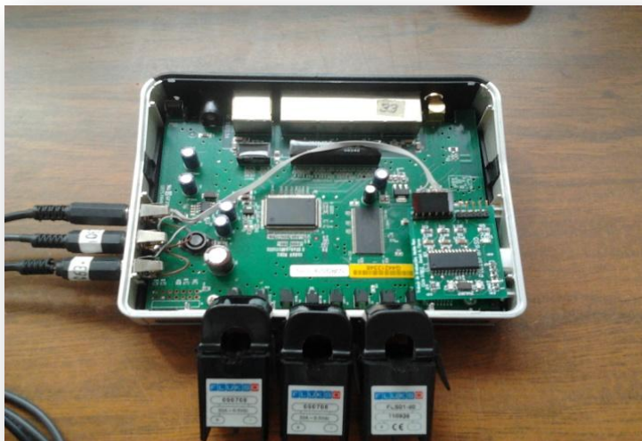
Figura 2.1.1. Acople de los Transductores de Corriente en el Medidor.
