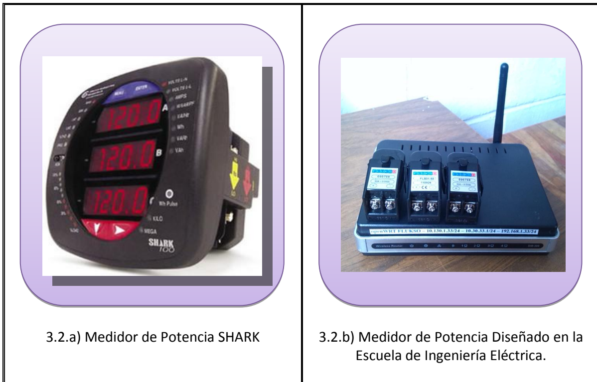
Figura 3.2.1: a) Medidor de Potencia SHARK y b) Medidor de Potencia Diseñado con la Escuela de Ingeniería Eléctrica.
