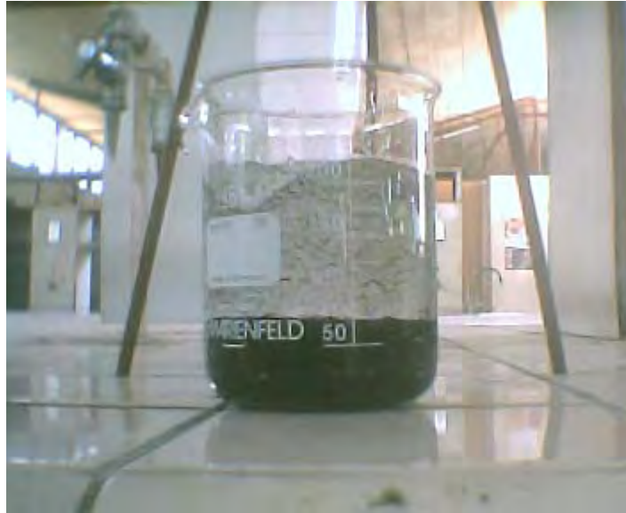
Figura No. 7. Muestra de fertilizante liquido con carbón activado en proceso de decoloración.
