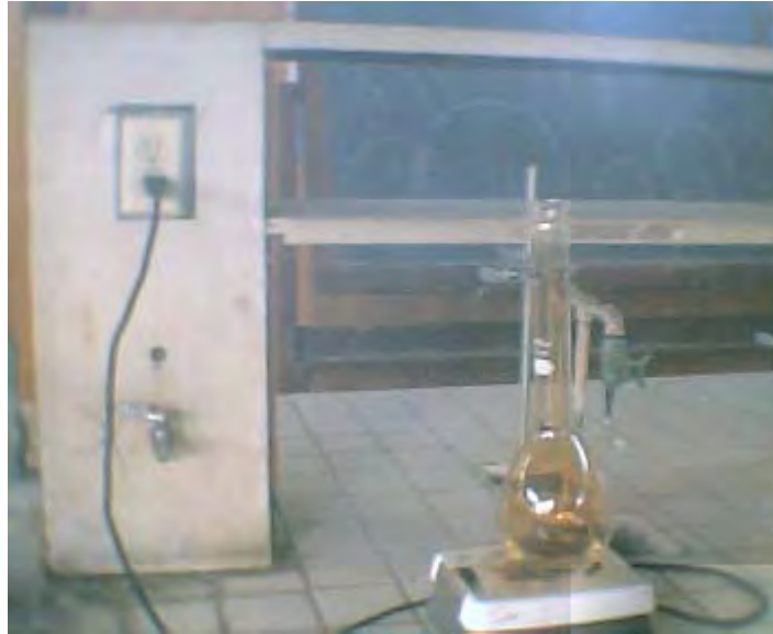
Figura No. 3. Calentamiento de la muestra. Hay un aumento en el Desprendimiento de gases.
