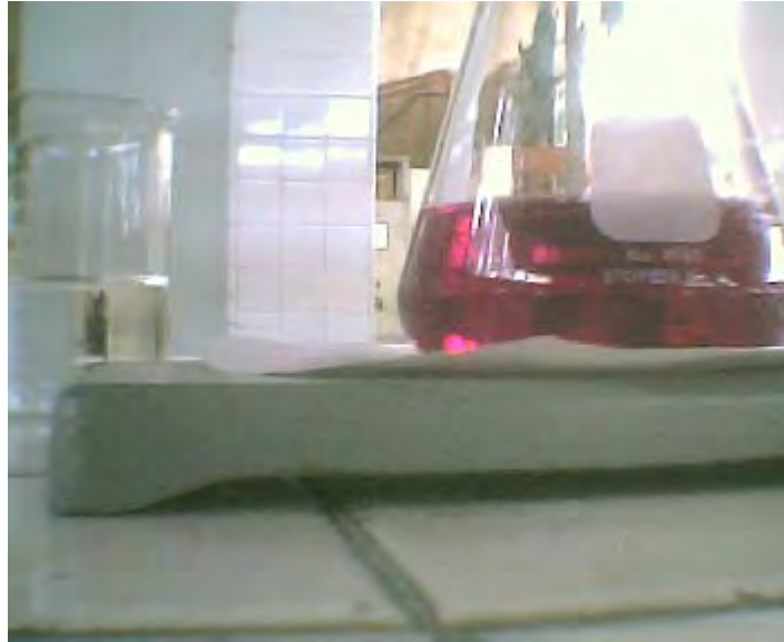
Figura No. 12. Determinación de Calcio. Titulación con SIn de EDTA 0.1M e indicador Murexide la sIn. vira de un color púrpura rosa.
