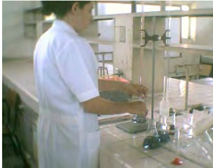
Figura No. 10. Determinación de Azufre. Titulación por retroceso con Sln. de Sulfato de Zinc, la solución vira de azul a un rojo vino.
