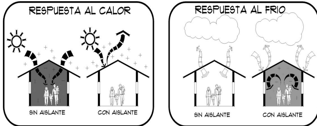
Fig. 29. Comportamiento de la lámina de polietileno.
