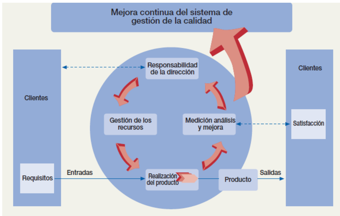
Ilustración 9: Modelo de un Sistema de Gestión de la Calidad basado en procesos (según ISO 9001:2008)
