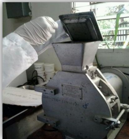
Figura N° 8: Proceso de cortado, secado y molido de las cáscaras de Musa sapientum (Banano).
