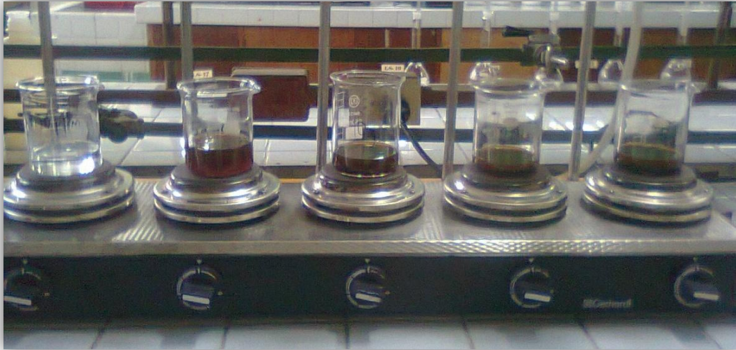
Figura N° 9: Filtrados en ebullición durante 10 minutos para eliminar impurezas orgánicas.
