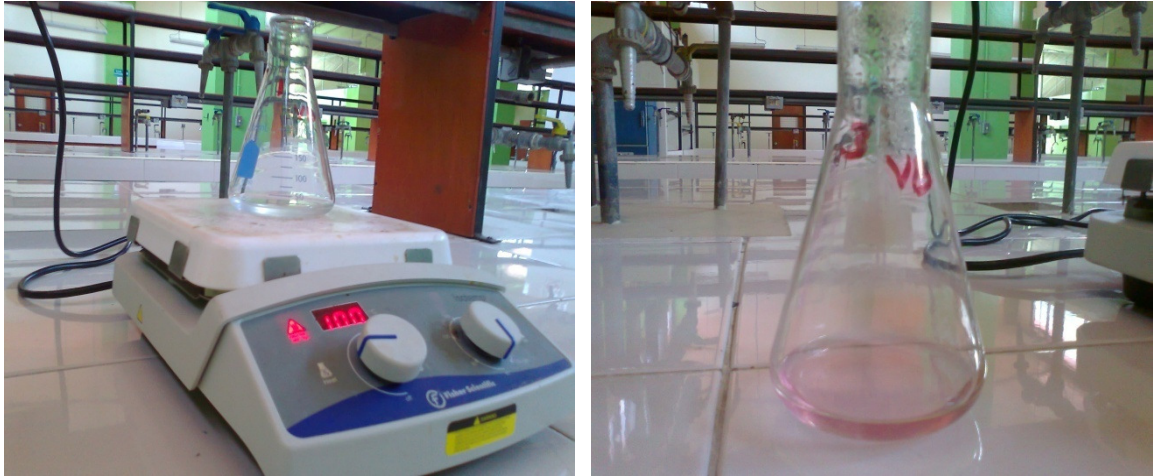
Fig. N°17. Demostración de viraje de color al realizar una valoración con Permanganato de potasio 0.1N
