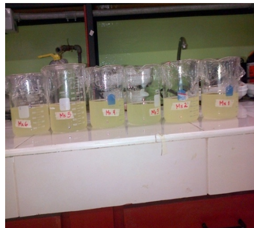
Fig. N°10. Marcas de leches utilizadas y suero obtenido al ser tratadas con HCl 0.1N
