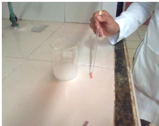
Fig. Nº14. Determinación de pH ácido y pH básico al precipitado de Oxalato de calcio.
