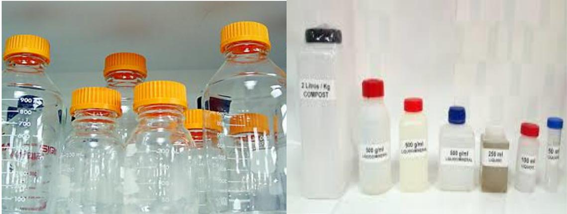
**Figura N° 2** Tipos de envases para la toma de muestra de aguas en ríos y lagos
