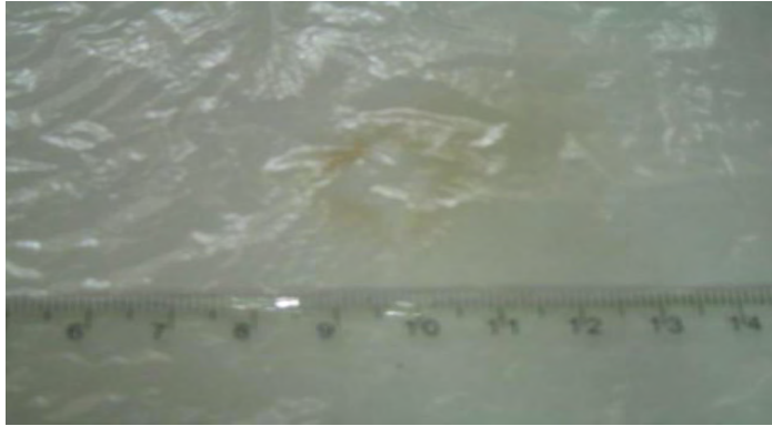
Fig. 22. Resultado positivo de la aplicación de la Técnica de Hoffmann.
