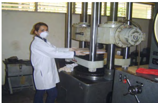
Fig. 8. Colocación del material que contiene la muestra de tela en la prensa.
