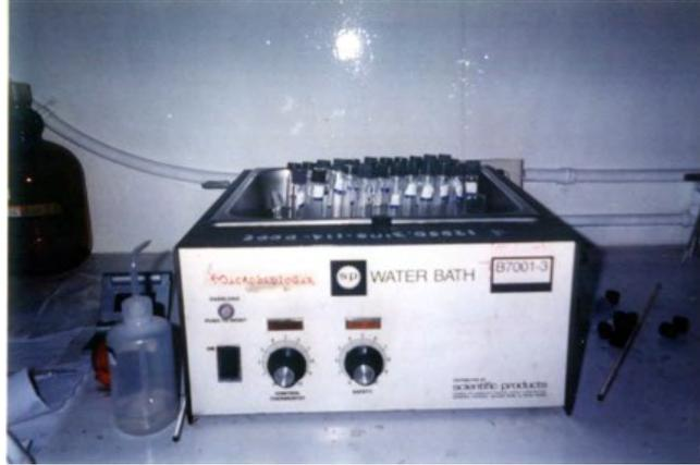
Figura 22. Introducción de tubos de ensayo en baño maría
