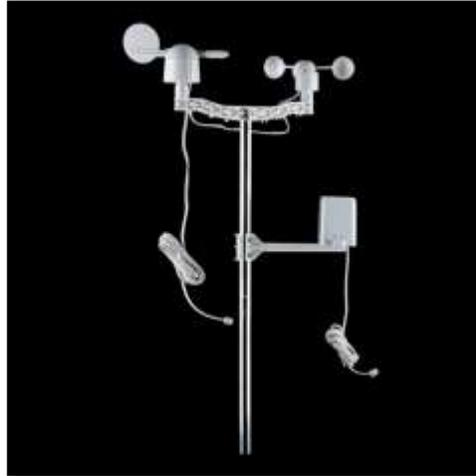
Figura 8. Estación meteorológica.
