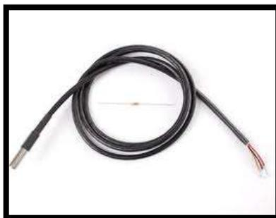
Figura 5. Sensor de temperatura digital DS18B20
