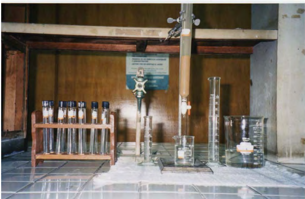
Figura No 22 Columna de filtración para retener plomo en solución.
