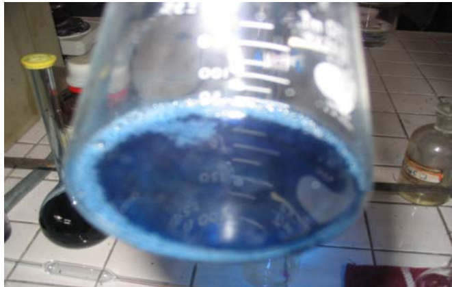
Figura No. 10 Preparación de la muestra con Índigo Carmín antes de valorar
