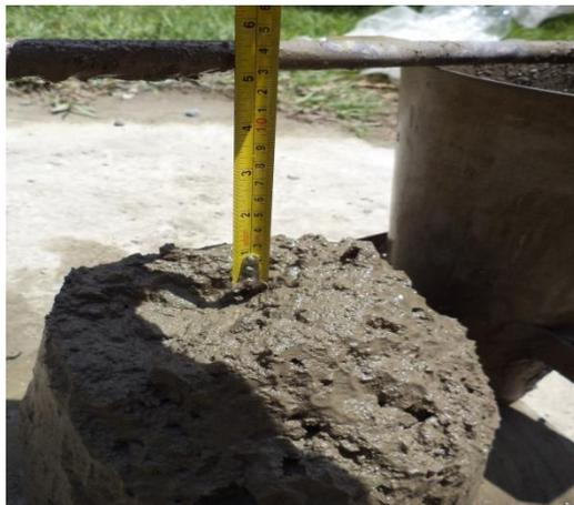
**Figura N° 5.7:** Revenimiento obtenido en la segunda mezcla para el diseño ANLI3.
