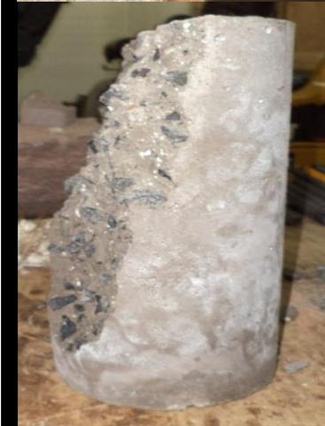
**Figura No 5.25:** Grieta en forma de columna vertical y cono no bien definido.
