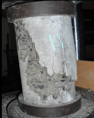
**Figura No 5.27:** Fractura diagonal con fisuras a través de los extremos.
