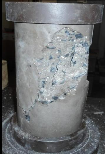
**Figura No 5.34:** Fractura diagonal con fisuras a través de los extremos.
