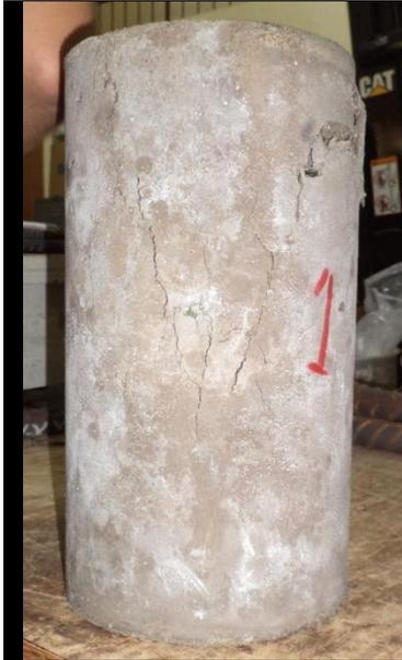
**Figura No 5.26:** Cono razonablemente bien formado en un extremo, con menos de 1" (25mm) de grieta a través de las tapas.
