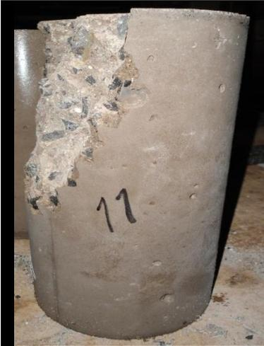
**Figura No 5.41:** Fractura en la parte superior.
