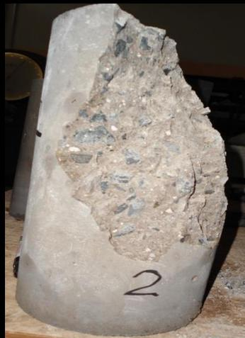
**Figura No 5.33:** Grieta en forma de columna vertical no bien definido y cono no bien definido.
