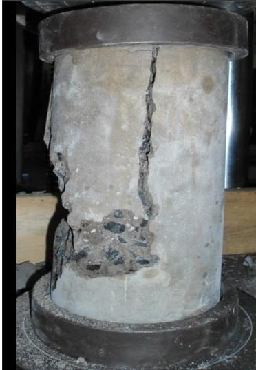
**Figura No 5.32:** Grieta vertical en forma columnar.
