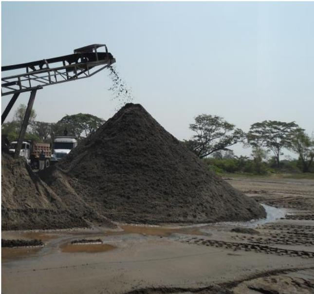
**Figura N° 2.9:** Arena natural Lavada Industrialmente (CANTERA S.A. 2013)
