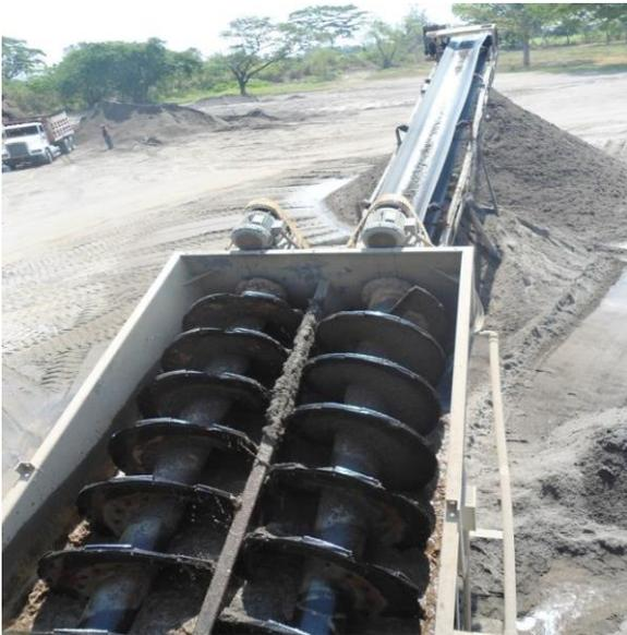
**Figura No 2.13:** Tornillos sin fin (Gusanos helicoidales)
