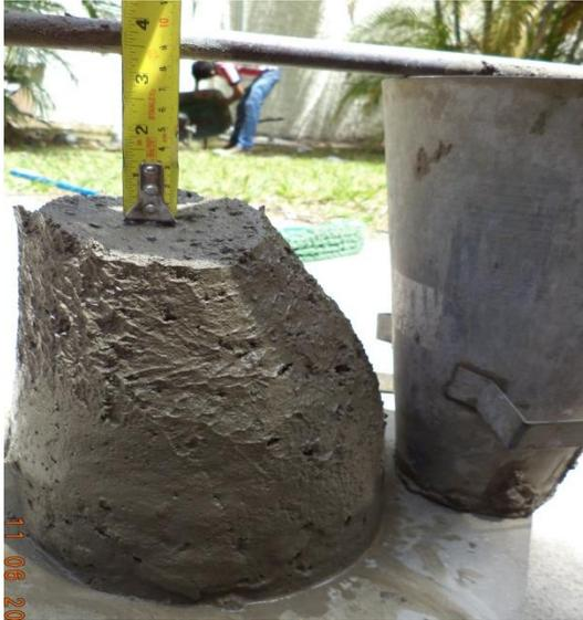
**Figura N° 5.12:** Revenimiento obtenido en la primera mezcla para el diseño CMBB.
