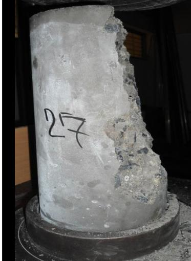
**Figura Nº 5.31:** Grieta en forma de columna vertical y cono no bien definido.
