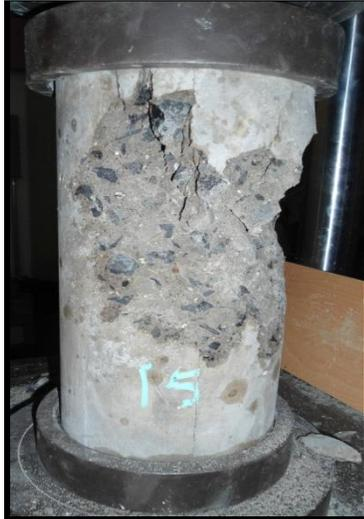
**Figura Nº 5.29:** Cono semi-formado en un extremo y grieta vertical que atraviesa la tapa.
