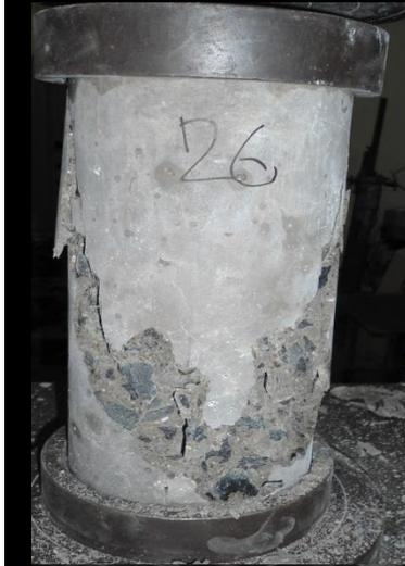
**Figura Nº 5.30:** Fractura diagonal con fisuras a través de los extremos
