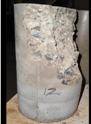
**Figura Nº 5.36:** Fractura en la parte superior
