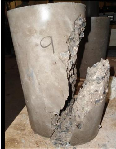
**Figura Nº 5.35:** Fractura diagonal con fisuras a través de los extremos y grieta no bien definida columnar.
