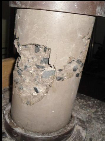
**Figura No 5.39:** Fractura diagonal con fisuras a través de los extremos.
