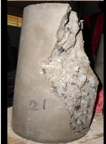
**Figura Nº 5.37:** Fractura columnar no bien definida con fisuras a través de los extremos.
