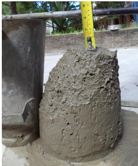
**Figura № 5.17:** Revenimiento obtenido en la segunda mezcla para el diseño CMBE.
