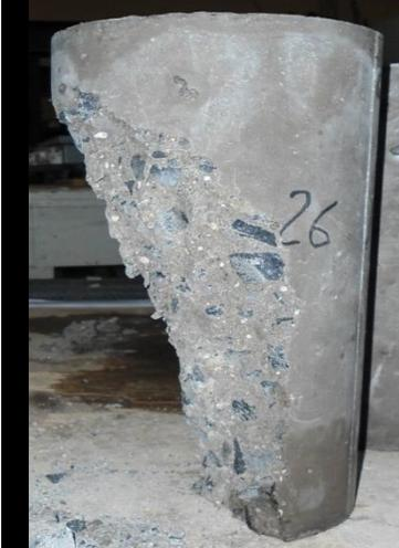
**Figura No 5.43:** Fractura diagonal con fisuras a través de los extremos.
