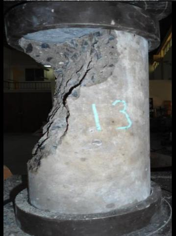
**Figura No 5.28:** Grieta en forma de columna vertical y cono no bien definido.
