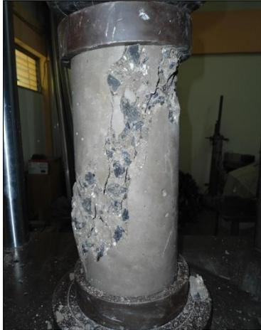
**Figura No 5.23:** Fractura diagonal con fisuras a través de los extremos.
