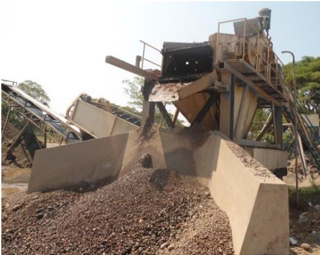
**Figura N° 2.12:** Proceso de cribado y evacuación del material de sobre tamaño.
