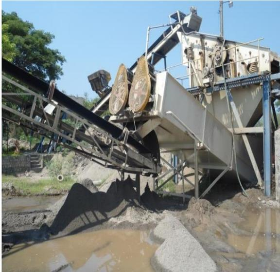
**Figura N° 2.11:** Máquina de lavado de arena (abril 2013).
