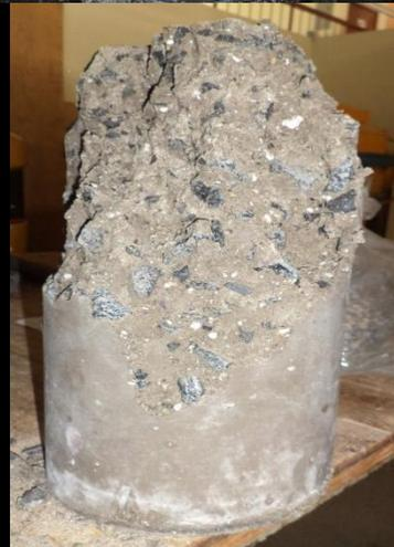
**Figura No 5.24:** Fractura diagonal con fisuras a través de los extremos.
