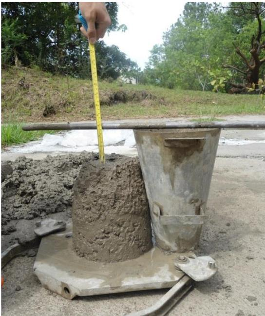
**Figura N° 4.17** Revenimiento obtenido para diseño CMBE.
