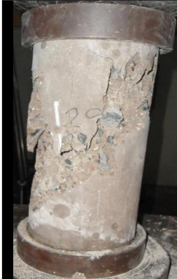
**Figura No 5.38:** Cono razonablemente formado en un extremo, con menos de 1" (25mm) de grieta a través de las tapas.
