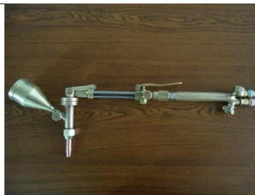
Accesorio de termorrociado ensamblado con maneral de oxicorte
