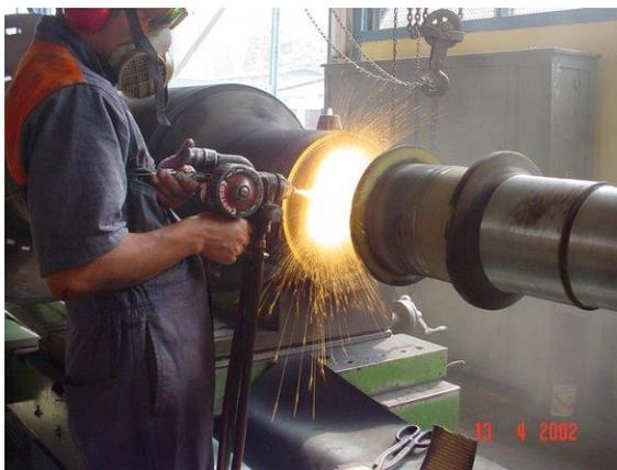
Fig. 1. 1. Proceso de termorrociado.
