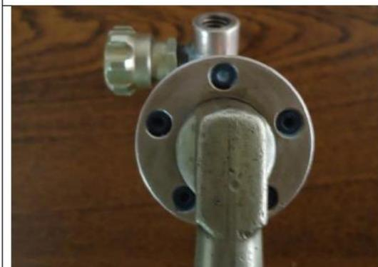
Brida de sujeción de mezclador
