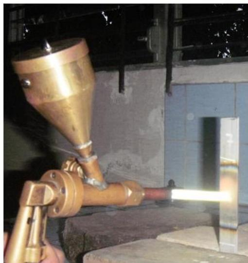
Fig. 3. 4. Proceso de Termorrociado
