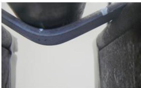
Fig. 3. 11. Probeta termorrociada N° 1.
