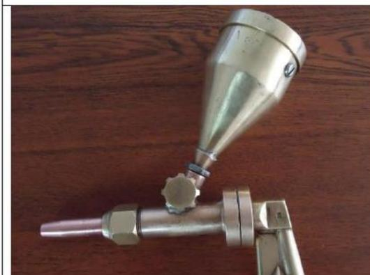
Mezclador, tolva y boquilla ensamblados
