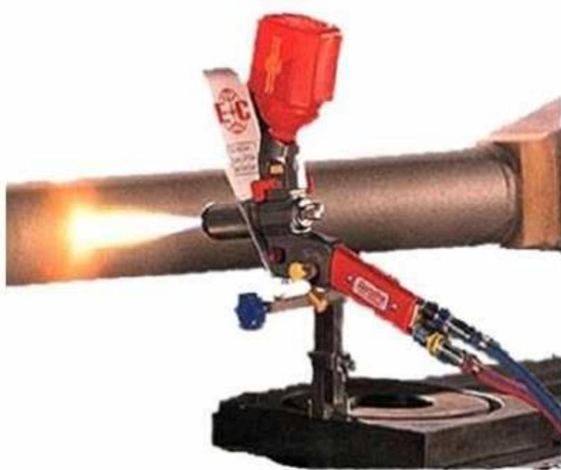
Fig. 1. 14. Pistola de termorrociado por flama con aspersion de polvos [18].
