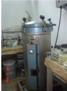
Figura N° 14 .Autoclave del Laboratorio de Microbiología.
