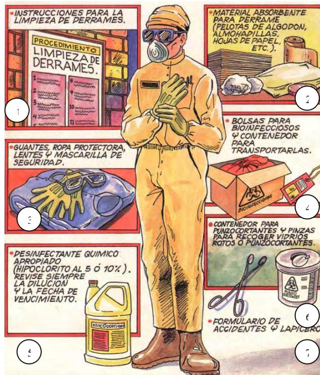
Fig. N° 70 Materiales básicos para el control de derrames.
