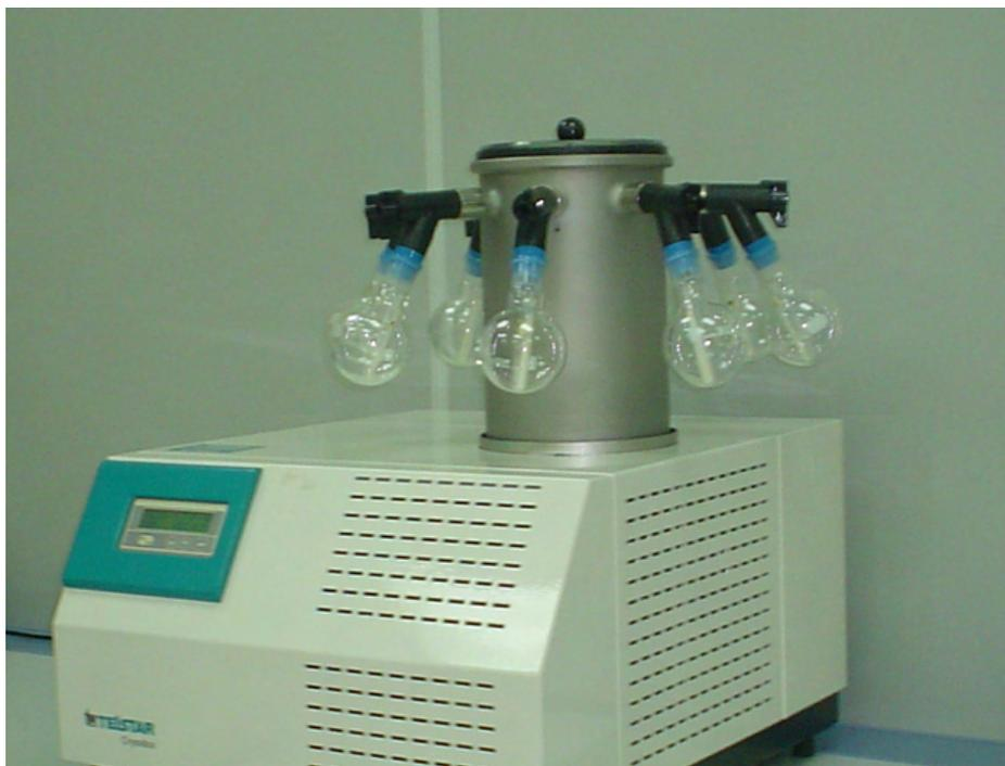
**Fig. N° 20 Equipo de liofilización del laboratorio de CENSALUD.**
