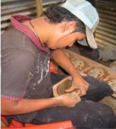
Posteriormente se continúa con la reproducción de las piezas usando moldes para simplificar el seriado según el diseño de la pieza original, ya que estas pueden ser simples o complejas,
