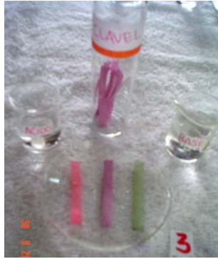
Figura N° 53. Viraje de color del Papel Indicador obtenido de Hibiscus rosa-sinensis (Clavel Simple), frente a un ácido y una base.
