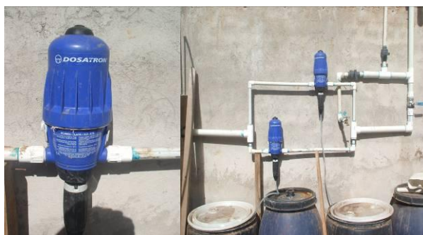
Imagen A 6. Aparato dosificador (Dosatron utilizado para aplicar los programas de fertilización)
