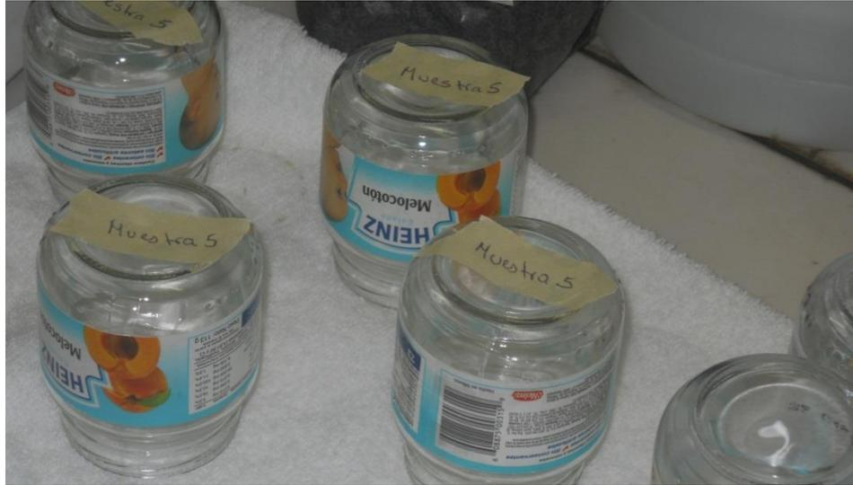
**Figura N°4:** Preparación de los frascos para almacenar porciones de las muestras compuestas para la elaboración de cada análisis.
