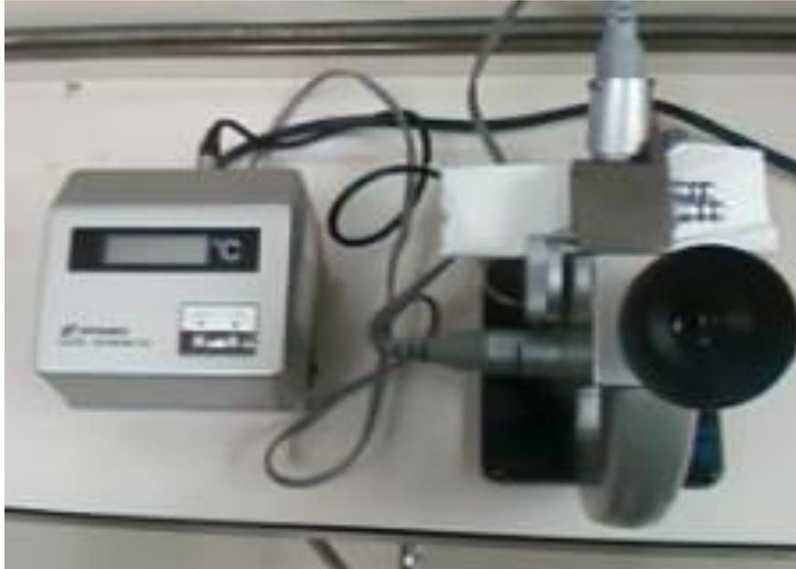
**Figura N°8:** Refractómetro utilizado en el análisis de grados brix.
