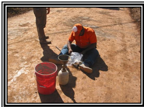
Fotografía 3.29 Toma de densidades por medio del Ensayo de Densidad de Campo
