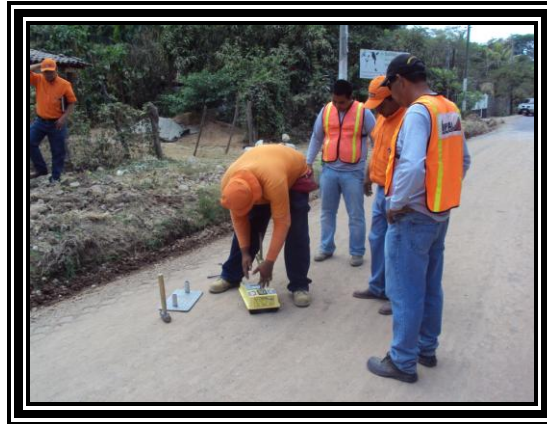
Fotografía 3.42 Toma de densidades por medio del Densímetro Nuclear
