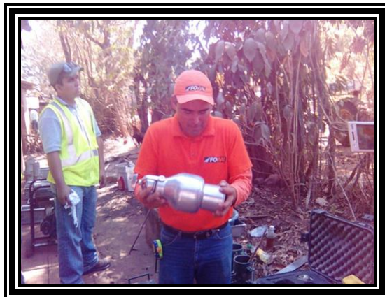
Fotografía 3.11 Chequeo de Humedad de la Mezcla por medio del Método “Speedy”
