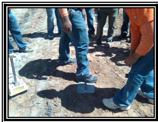
Fotografía 3.28 Toma de densidades por medio del Densímetro Nuclear
