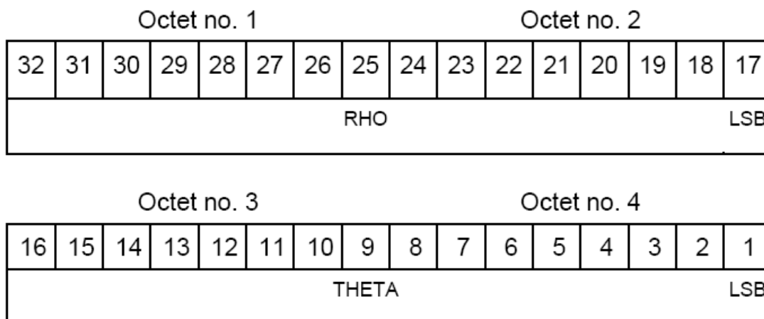
Figura 2.15: Estructura de los cuatro octetos del Item de datos I001/040
