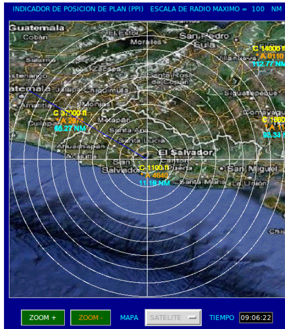
Figura 3.11: Visualización de plots en PPI a una escala de radio máximo de 100 NM
