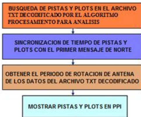
Figura 3.10: Flujograma en bloques del algoritmo utilizado para el análisis de visualización radar
