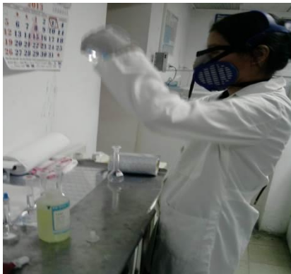
Fig. N° 19: Preparación de estándares para la curva de calibración.
