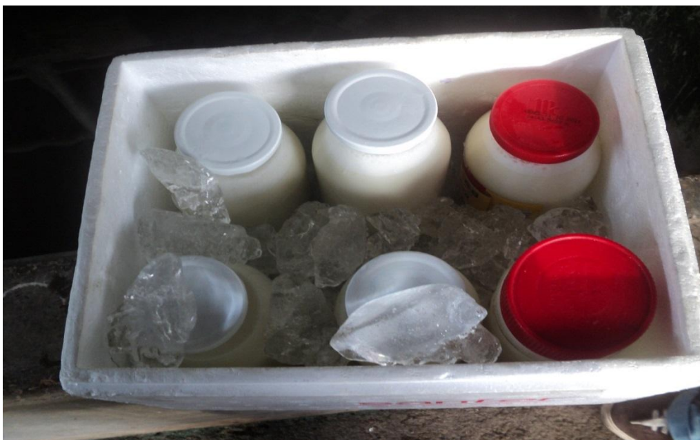
Figura A-8 Transporte de muestras en hielera con hielo en condiciones de refrigeración de 4 – 6 °C.
