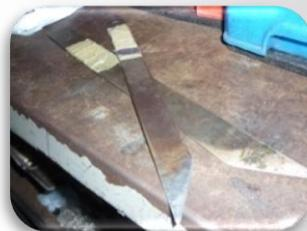
**Riesgo de cortadura herramientas en mal estado**
