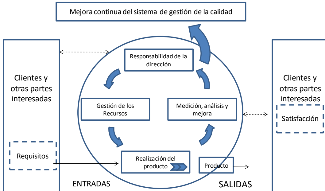
Figura A2.1. Modelo de un sistema de gestión de calidad basado en procesos según la serie de normas ISO 9000. Las flechas continuas añaden valor y las discontinuas son flujo de información.
