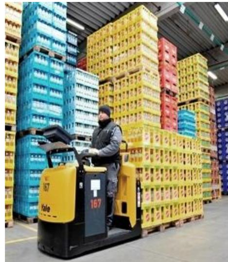
3. Carretillas (Forklifts): Sirven para mover paletas y contenedores, varían enormemente de peso y altura, pudiendo mover contenedores cargados. Pueden aplicárseles útiles específicos para mover mercancías especiales, tales como: Bobinas, línea blanca, madera, etc.
