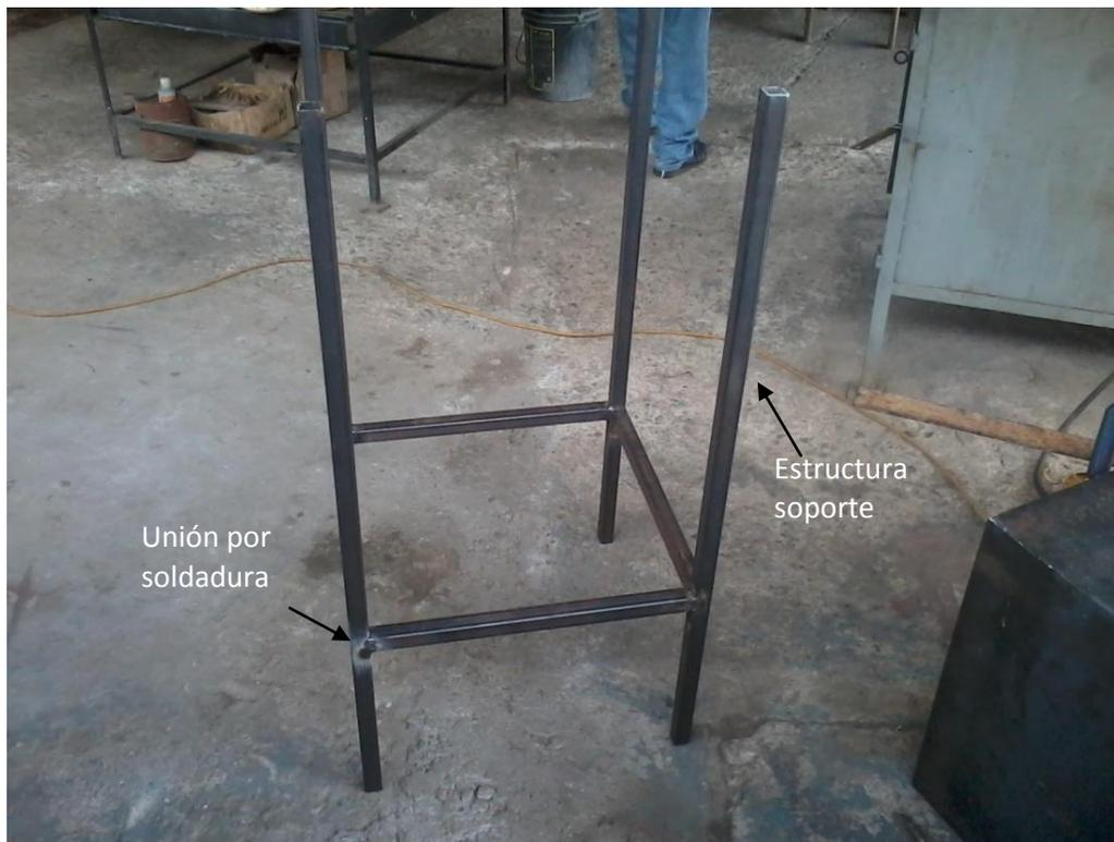
Fig. 3.2. Montaje de la estructura soporte.
