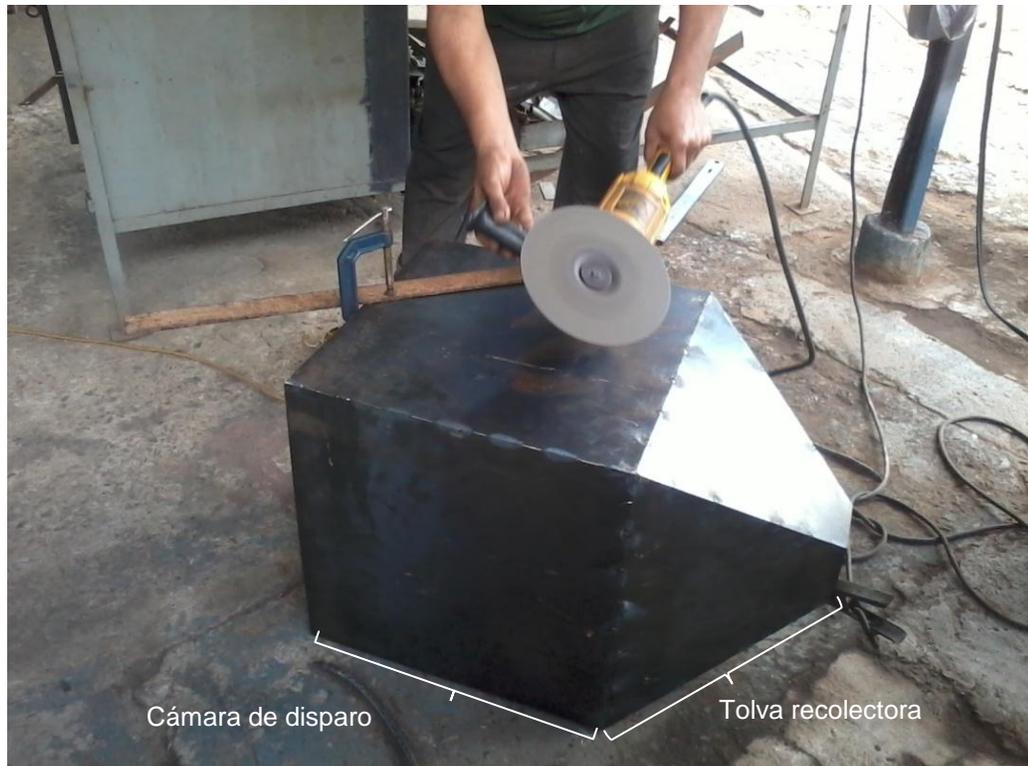
Fig. 3.1. Corte en la cámara de disparo, para la colocación de ventana visor.
