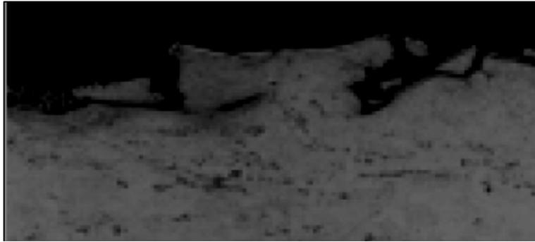
Fig. 1.6. Daño de superficies creado por granallas rotas, 100x.
