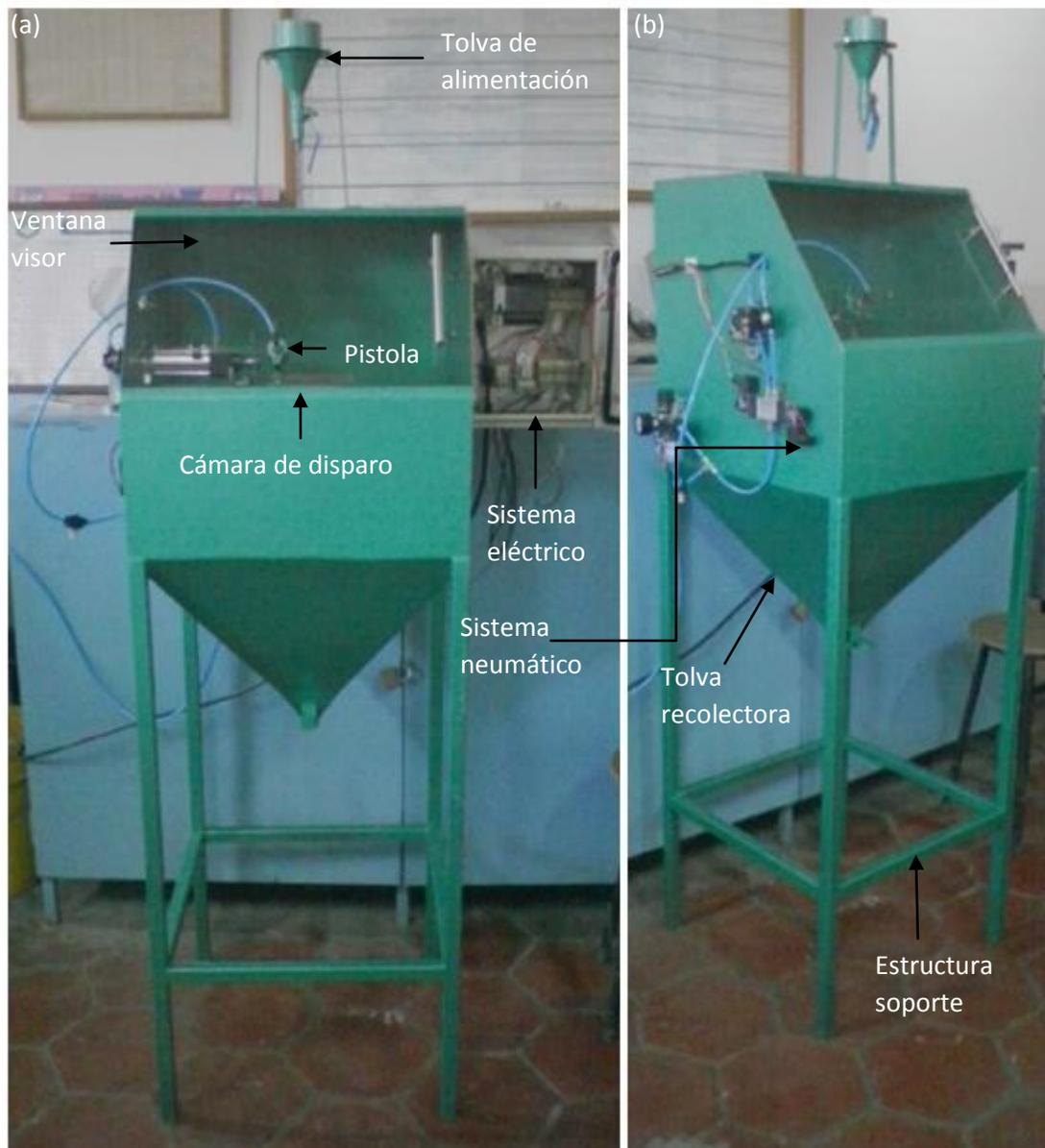
Fig. 3.9. Sistema electroneumático de granallado: (a) vista frontal y (b) vista lateral.
