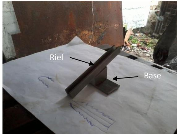
Fig. 3.5. Montaje del riel base de pistola.
