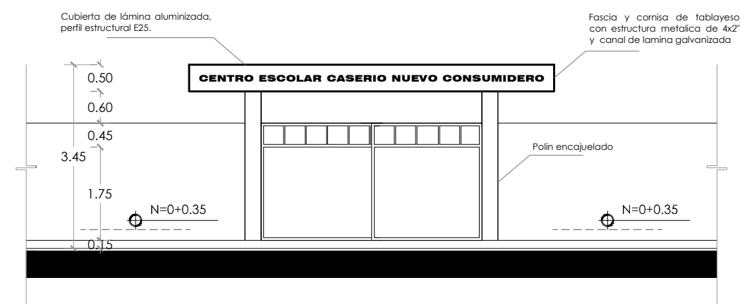
DETALLE DE ACCESO PRINCIPAL Esc. 1:100
